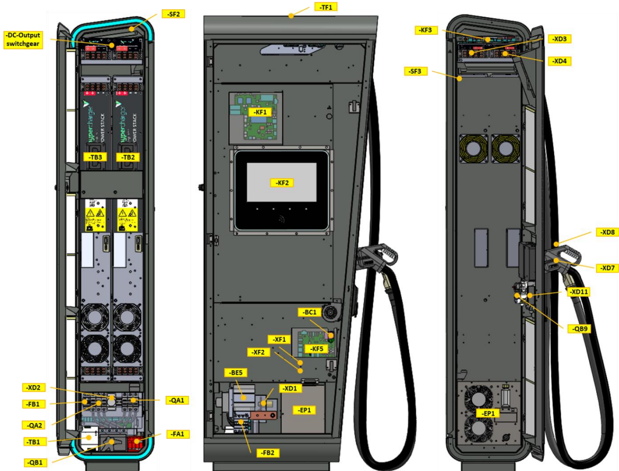
Abbildung 13: Innenansicht hypercharger HYC_150 (Service-, Display-, Ladekabelseite)
