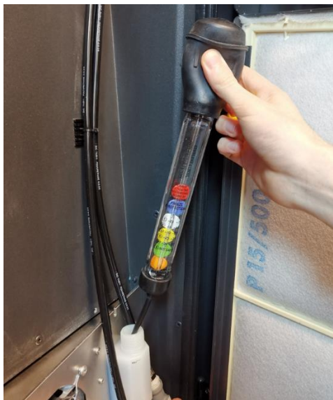
Abbildung 84: Überprüfung der Konzentration mit einem Refraktometer
