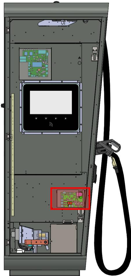
Abbildung 29: Position der CTRL_EXT im hypercharger
