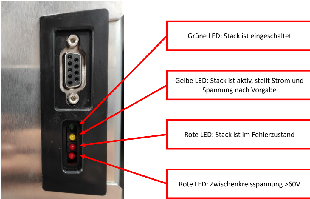
Abbildung 18: Statusanzeige Power-Stack
